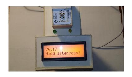
Если температура тела, считываемая датчиком, ниже или выше нормы, то загорается желтый светодиод, визуализирующий запрет на проход на территорию организации.
