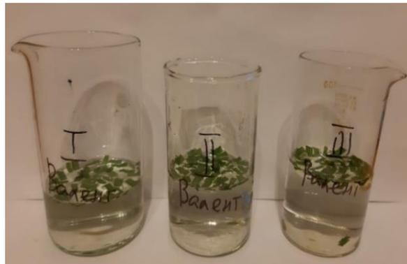
Определение степени выхода электролитов сквозь мембраны листьев с помощью измерителя электропроводности и температуры
