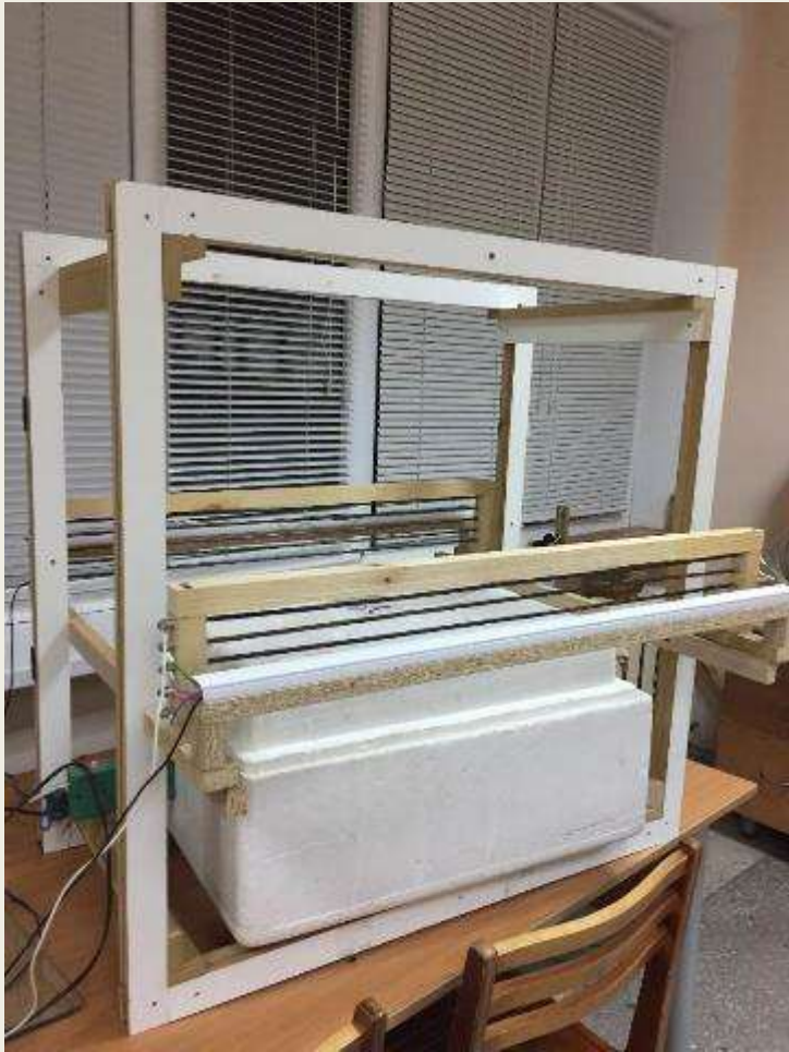
Фото 2. Внешний вид инкубатора в катушках Гельмгольца
