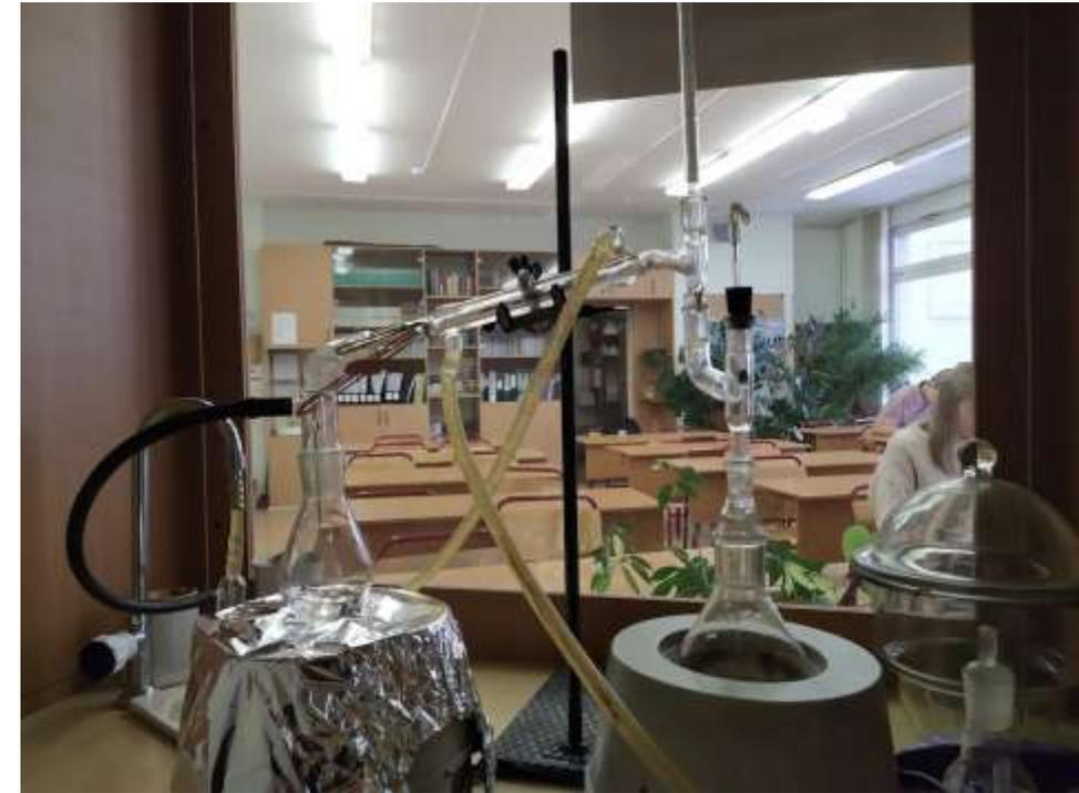
Установка для перегонки при
