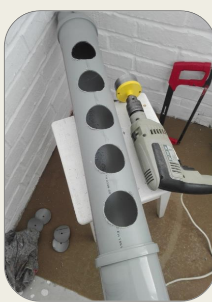
Труба \varnothing 50 \times 2000 мм
