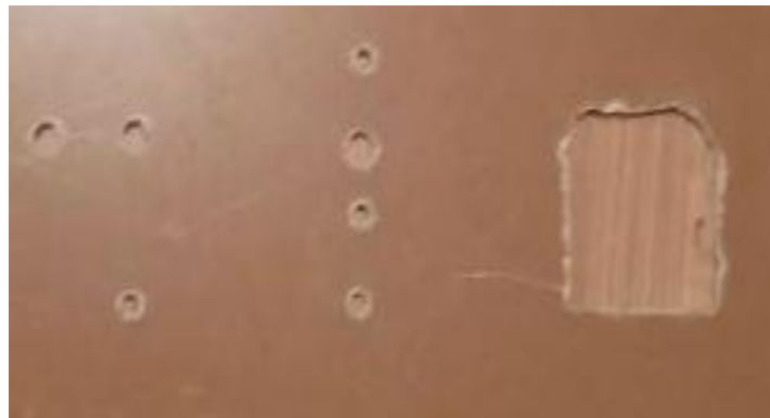
Высверливание отверстий под элементы платы
