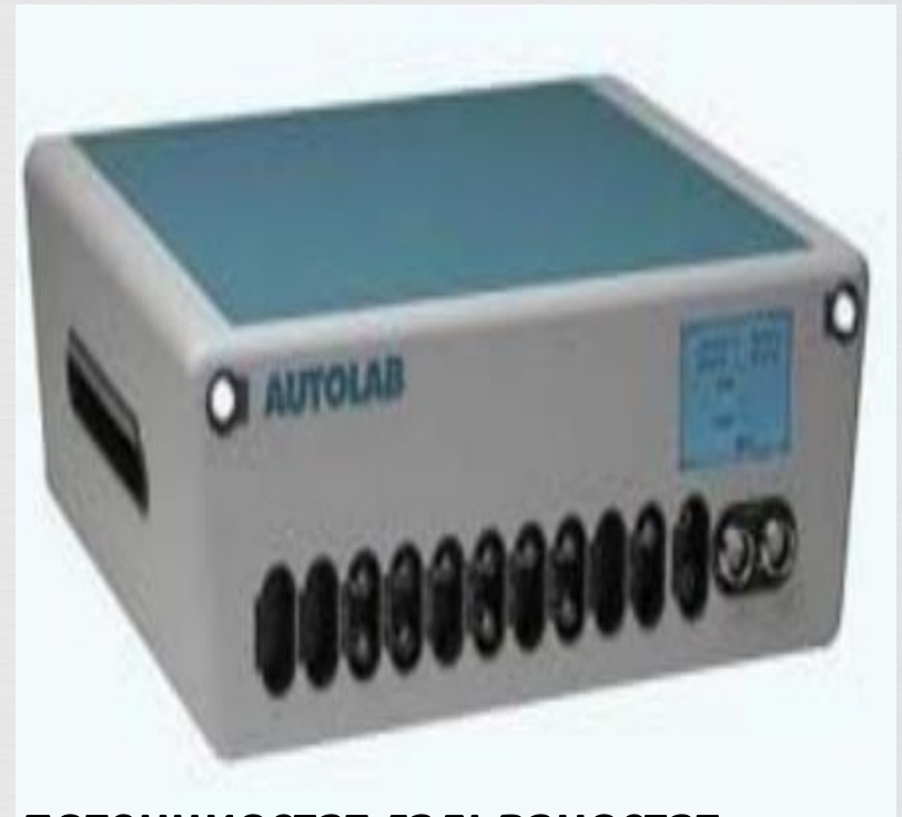
Рис. 1. (а) – ячейка симметричного СК, (б) – потенциостат-гальваностат Autolab 302N
