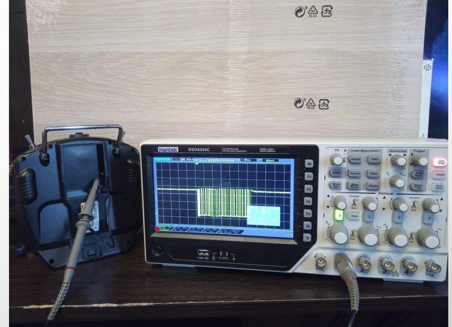
3) Считывание сигналов с пульта управления и отображение результатов на осциллографе.
