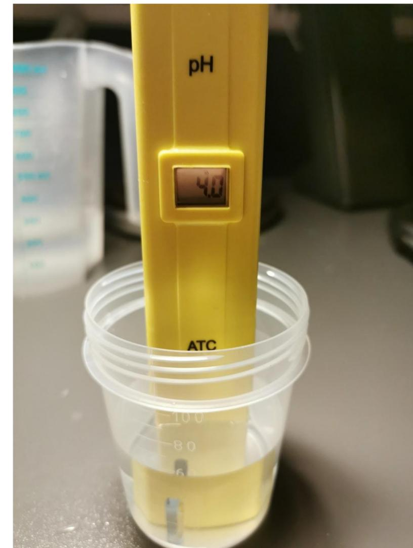
Измерение показателя кислотности воды
